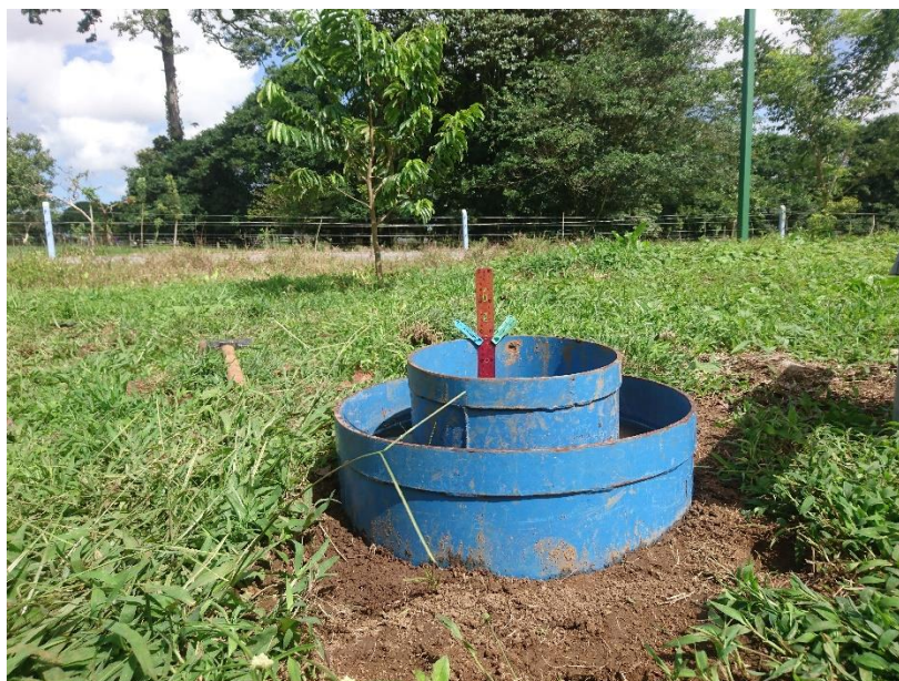
Foto 1. Anillos utilizados en prueba de infiltración #16.
