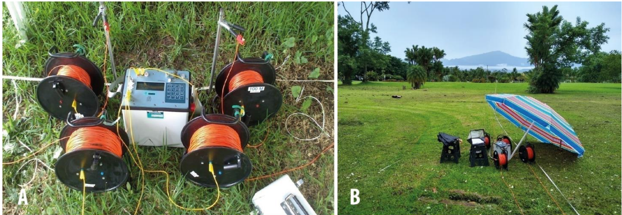
Foto 10. A) Equipo utilizado para realizar los sondeos eléctricos verticales (SEV). B) SEV realizado en las cercanías del margen izquierdo del Río Chirripó, vista hacia el sur en donde se aprecia el macizo volcánico Turrialba.
