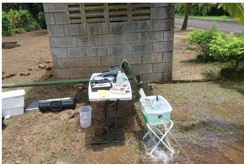
Foto 2. Celda de flujo y equipos utilizados para muestrear pozos.
